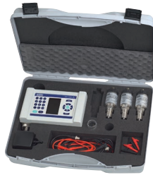
Variante 1: Maletín de calibración con un máximo de 5 sensores de presión
