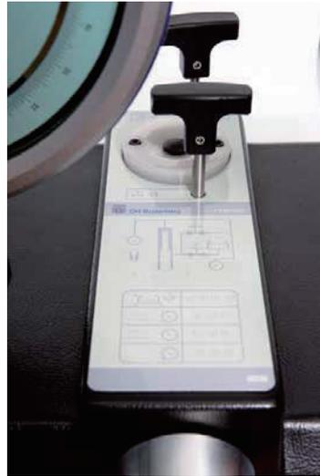
CPB3800仪表底座上的控制示意图
