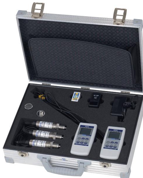
Exemple de valise de service (température et pression)
