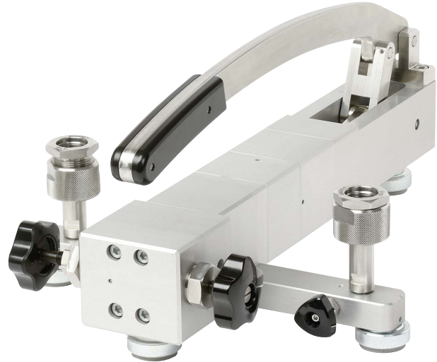
Bomba de teste comparativa modelo CPP140-M
