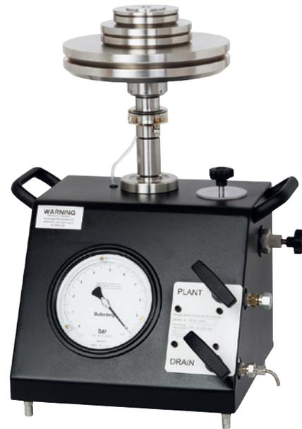
Tester idraulico per tubazioni, modello 80
