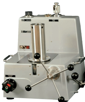
Balance manométrique étalon primaire, gamme CPB6000
