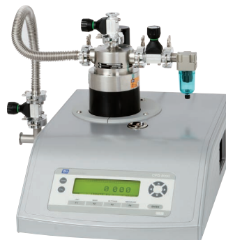
Balance manométrique digitale, type CPD8000
