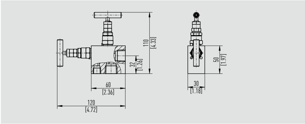
**Modelo IV2C1, diseño plano, posición del bonete en ángulo, montaje con brida integral**
