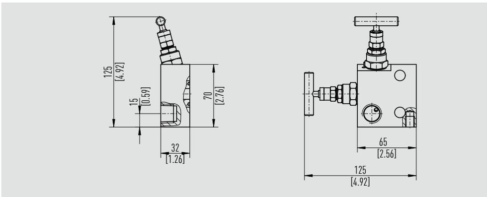
**Modelo IV2F8, diseño plano, posición de purga del bonete en 45°, montaje directo con brida**
