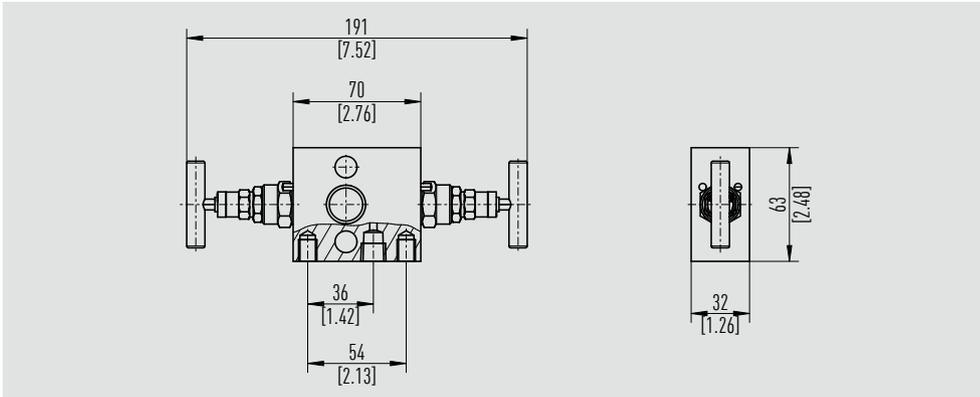
**Modelo IV2F7, diseño plano, posición del bonete en L, montaje directo con brida**
