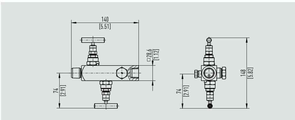
**Modelo IV291, diseño plano, posición del bonete en ángulo, conexiones en ángulo**
