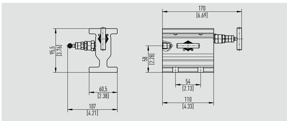
**Modelo IV2T1, diseño en T, posición del bonete en ángulo, montaje directo con brida**
