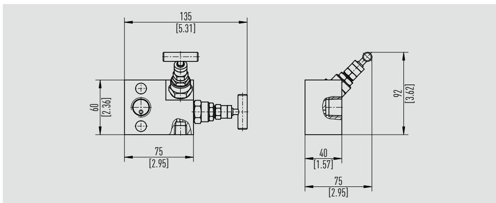
**Modelo IV2H1, diseño en H, posición del bonete en ángulo, montaje directo con brida**
