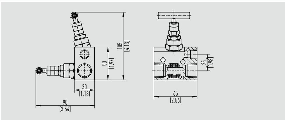
**Modelo IV212, diseño plano, posición del bonete en línea, conexiones en línea**
