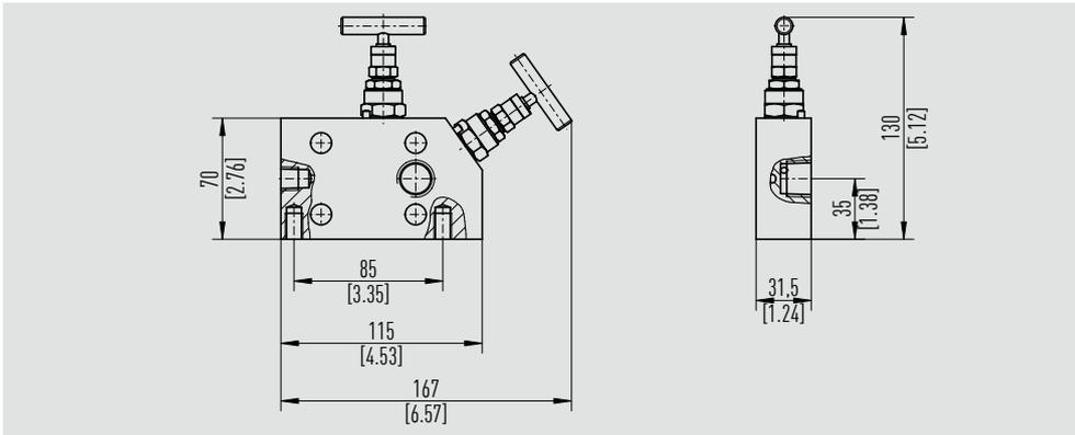
**Modelo IV2F2, diseño plano, posición del bonete en línea, montaje directo con brida**
