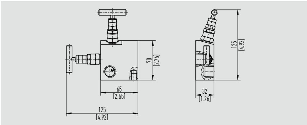
**Modelo IV222, diseño cuadrado, posición de bonete en línea, conexión doble para salida de presión**
