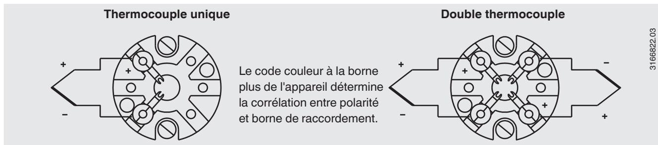
Pour les raccordements électriques des transmetteurs de température intégrés (en tête), consulter les fiches techniques ou modes d'emploi correspondants.
