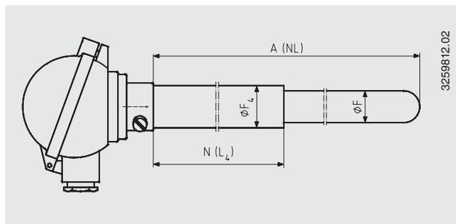
Размеры для исполнения с защитной гильзой  $\varnothing < 24$  мм
