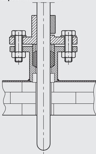
Пример установки: термопара с керамической защитной гильзой
