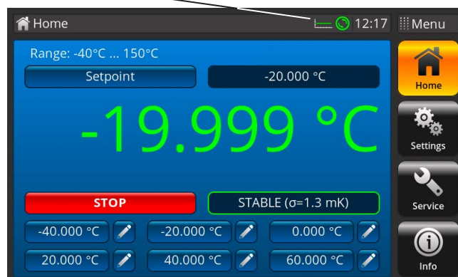
Critère de stabilité atteint
