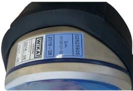
**Fig. 3 - CPG1500 con guscio di protezione della cassa**
