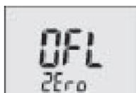
**OFL/Zero** s'affiche pendant 3 secondes si la pression mesurée (0 bar) est supérieure à 5 % de l'étendue de mesure.
