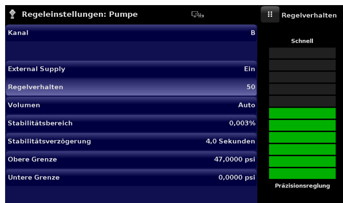
Abb. 6.4.3.3 - Regelverhalten des Pumpmoduls
