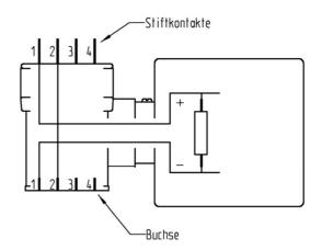
Sollte Ihr Transmitter die 'Signal/GND'-Leitung nicht auf Kontakt 2 und die '+Ub'-Leitung nicht auf Kontakt 1 haben, so müssen Sie den A-Al-2 - Winkelstecker und den externen Winkelstecker dementsprechend anpassen: Öffnen Sie hierzu den A-Al-2 - Winkelstecker und tauschen Sie die Drähte von Kontakt 1 und Kontakt 2 so aus, dass diese dem Anschluss Ihres Transmitters entsprechen.
