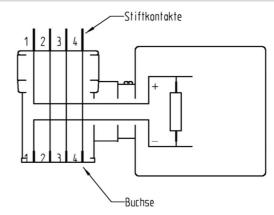
Sollte Ihr Transmitter die '+Ub'-Leitung nicht auf Kontakt 1 haben, so müssen Sie den A-AI-2-Winkelstecker und den externen Winkelstecker dementsprechend anpassen: Öffnen Sie hierzu den A-AI-2-Winkelstecker und tauschen Sie die Drähte von Kontakt 1 so aus, dass diese dem Anschluss Ihres Transmitters entsprechen.
