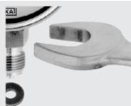
Pour les filetages parallèles, utiliser des joints d'étanchéité plats, des bagues d'étanchéité de type lentille ou des joints à écrasement WIKA sur la face d'étanchéité ①. Pour des filetages coniques (par exemple des filetages NPT), l'étanchéité doit se faire sur les filetages ② en utilisant un matériau d'étanchéité approprié (EN 837-2).
