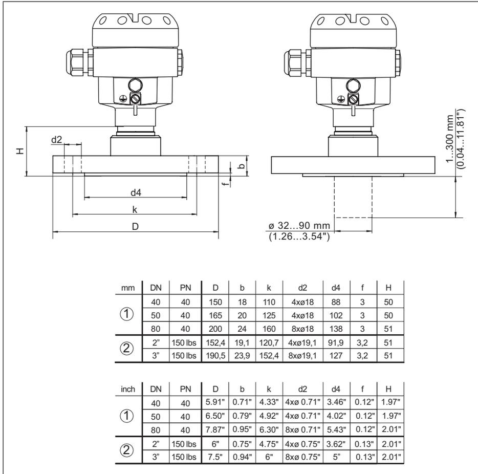
Fig. 52: CPT-2x, raccord à bride
