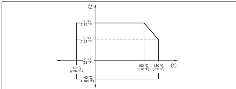
Fig. 39: Derating de température CPT-2x, version jusqu'à +130 °C (+266 °F)
