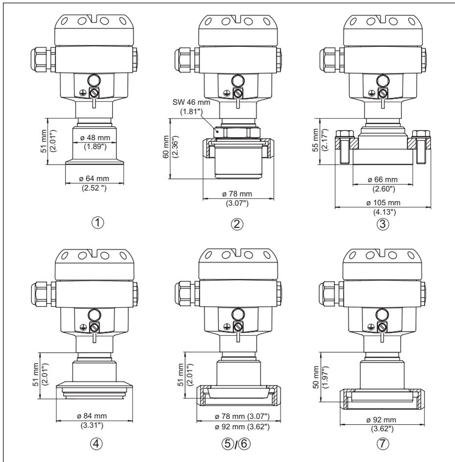
Fig. 51: CPT-2x, raccord aseptique
