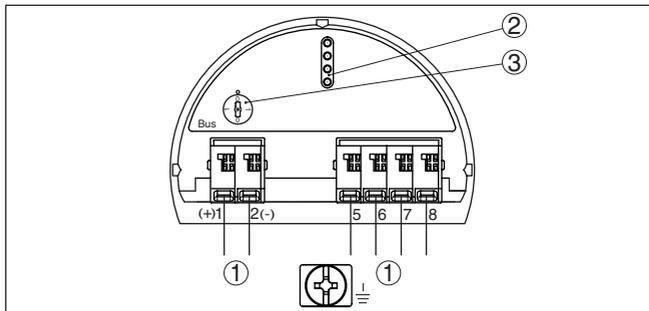
Fig. 21: Compartiment électronique - boîtier à deux chambres
