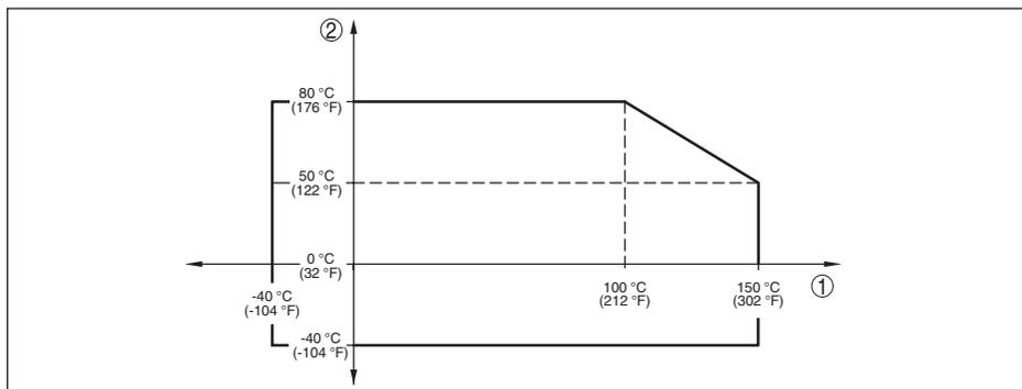
Fig. 40: Derating de température CPT-2x, version jusqu'à +150 °C (+302 °F)
