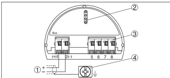
Fig. 22: Compartiment de raccordement - boîtier à deux chambres
