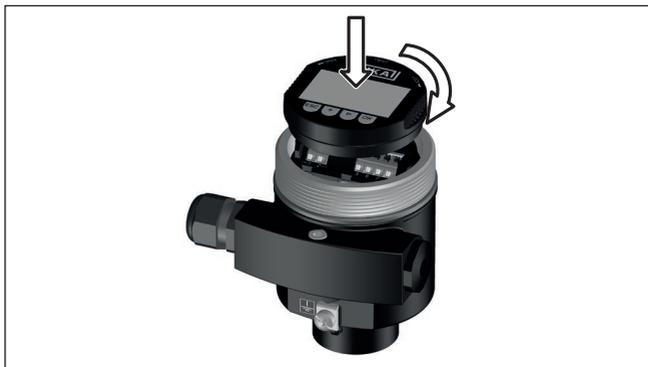
Fig. 30: Montage du module d'affichage et de réglage dans le boîtier à chambre unique se trouvant dans le compartiment de l'électronique
