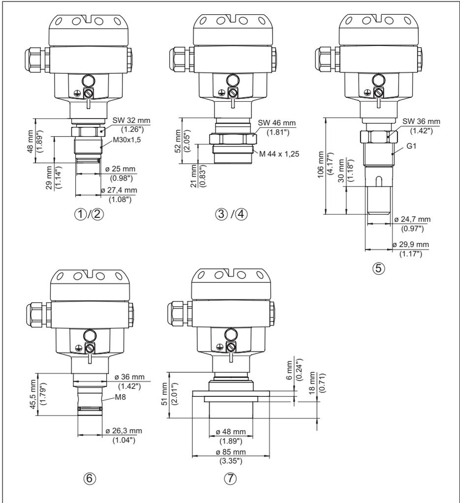
Abb. 54: CPT-2x, Tubusanschluss
