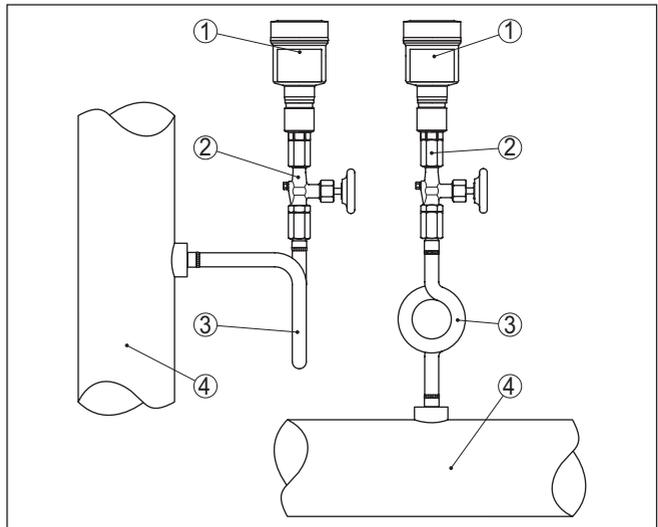
Abb. 15: Messanordnung bei Prozessdruckmessung von Dämpfen in Rohrleitungen
