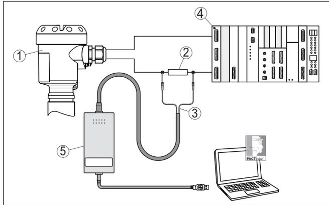
Abb. 33: Anschluss des PCs via HART an die Signalleitung
