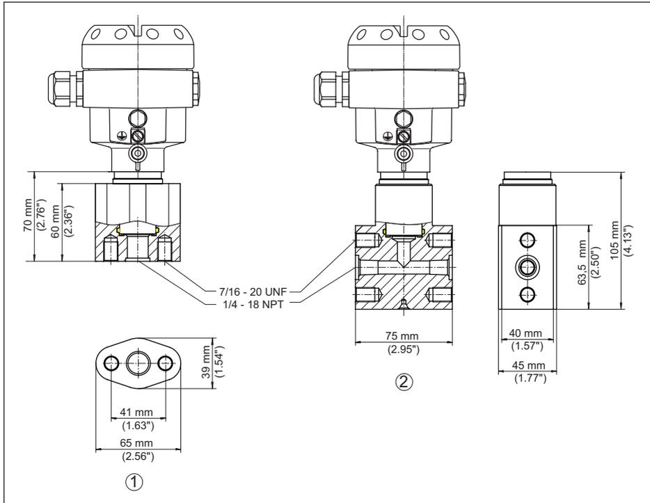
Abb. 55: CPT-2x, Anschluss nach IEC 61518
