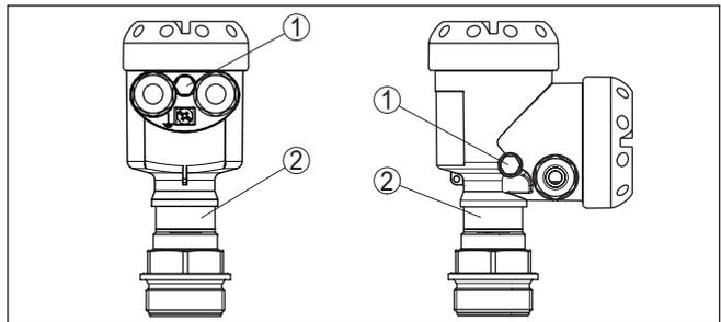
Abb. 12: Position des Filterelementes - gasdichte Durchführung
