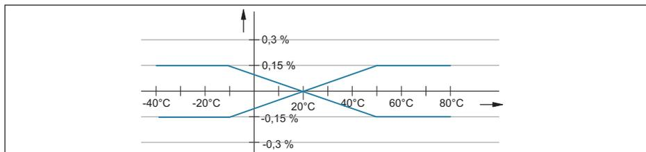
Abb. 39: Thermische Änderung Stromausgang
