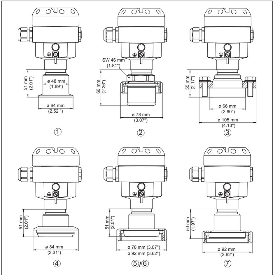
Abb. 52: CPT-2x, Hygieneanschluss
