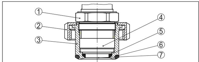
Abb. 34: CPT-2x, Aufbau aseptischer Anschluss mit Nutüberwurfmutter
