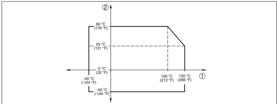
Abb. 40: Temperaturderating CPT-2x, Ausführung bis +130 °C (+266 °F)
