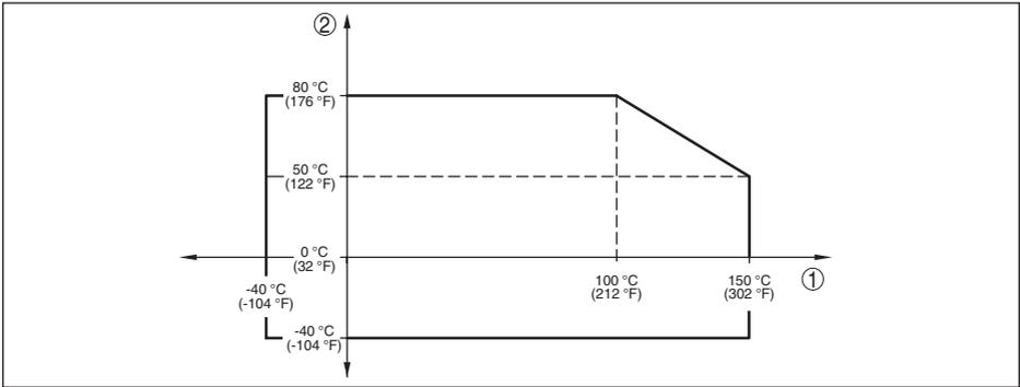
Abb. 41: Temperaturderating CPT-2x, Ausführung bis +150 °C (+302 °F)
