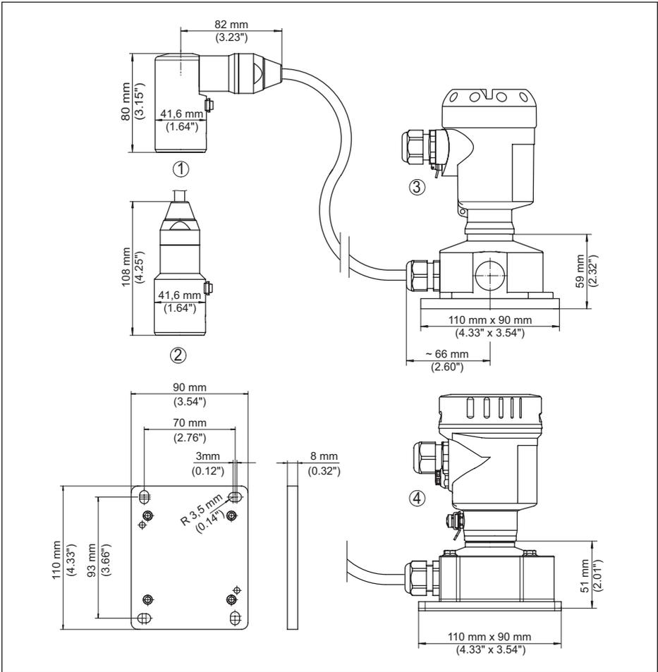
Abb. 49: IP68-Ausführung mit externem Gehäuse
