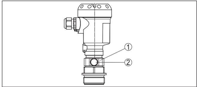
Abb. 11: Position des Filterelementes - Ex d-Ausführung
