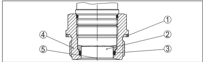
Abb. 4: Frontbündiger Einbau der Messzelle (Beispiel: Gewinde G1½)
