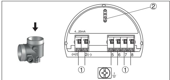
Abb. 22: Elektronikraum - Zweikammergehäuse
