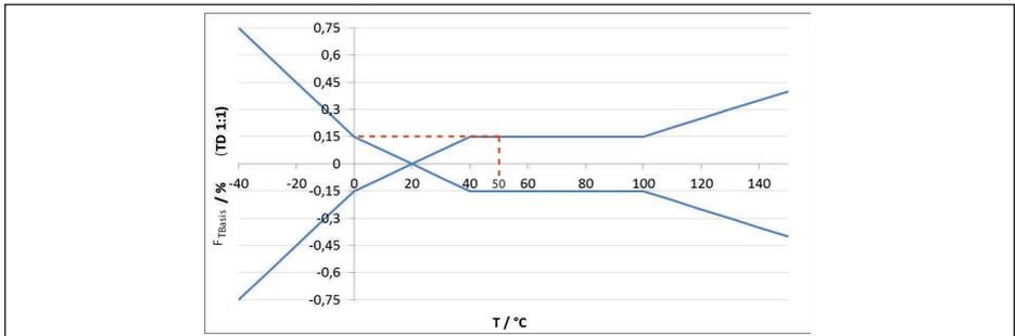
Abb. 42: Ermittlung des Basis-Temperaturfehlers für das Beispiel oben:  $F_{\text{TBasis}} = 0,15 \%$
