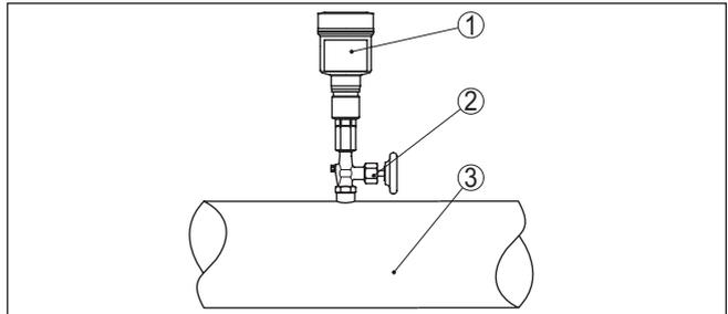
Abb. 14: Messanordnung bei Prozessdruckmessung von Gasen in Rohrleitungen
