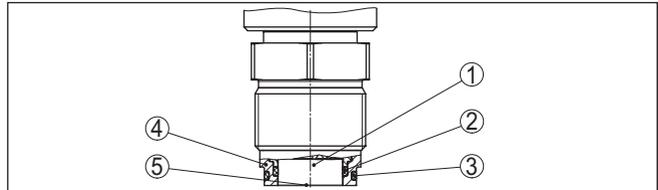
Abb. 5: Frontbündiger Einbau der Messzelle (Beispiel: M30 x 1,5)
