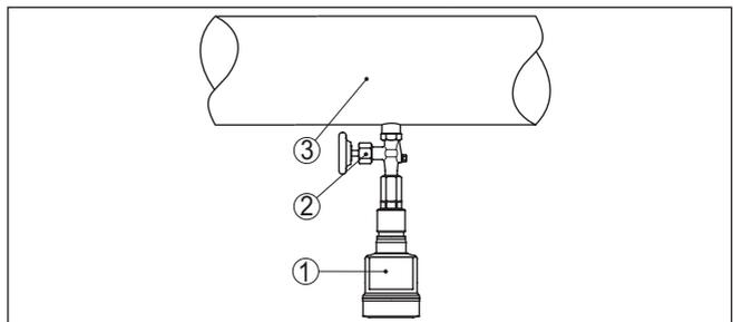
Abb. 16: Messanordnung bei Prozessdruckmessung von Flüssigkeiten in Rohrleitungen
