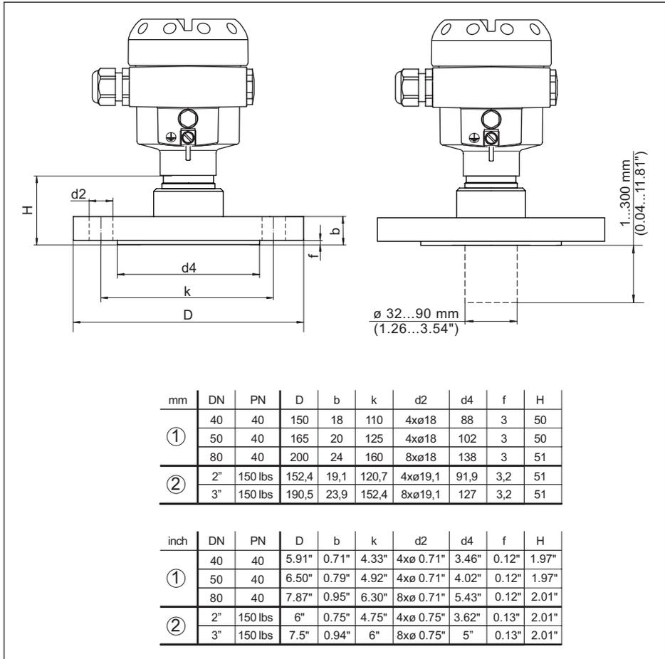
Abb. 53: CPT-2x, Flanschanschluss
