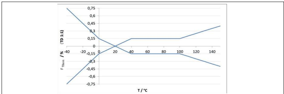
Abb. 38: Basis-Temperaturfehler  $F_{TBasis}$  bei TD 1 : 1
