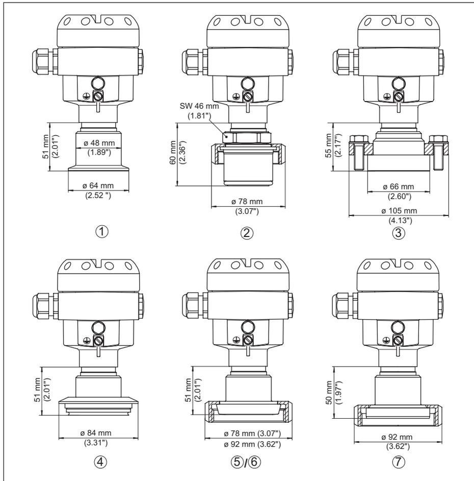
Fig. 52: CPT-2x, conexión aséptica
