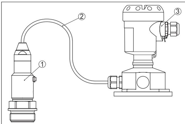
Fig. 24: CPT-2x en versión IP68 25 bar con salida de cable axial, carcasa externa
