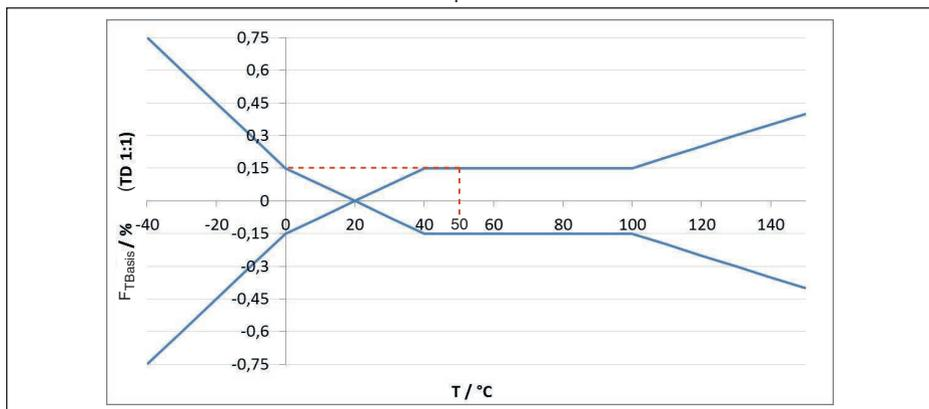
Fig. 42: Determinación del error de temperatura básico para el ejemplo anterior:  $F_{TBasis} = 0,15 \%$
