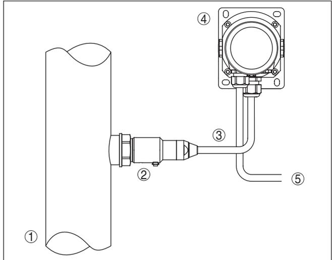
Fig. 18: Disposición módulo de proceso, carcasa externa
