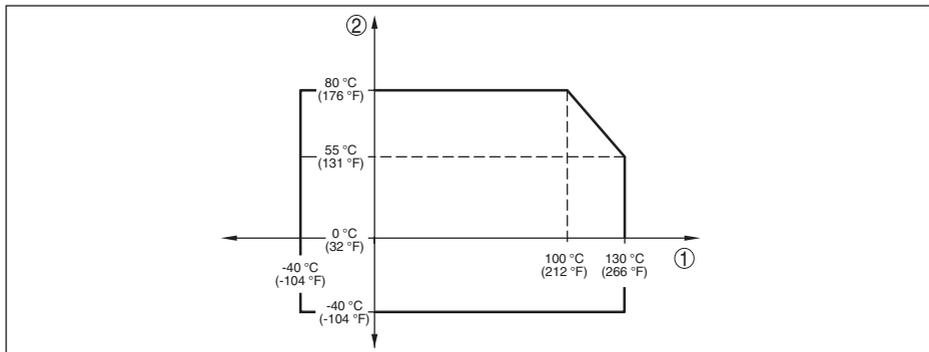
Fig. 40: Reducción de temperatura CPT-2x, versión hasta +130 °C (+266 °F)
