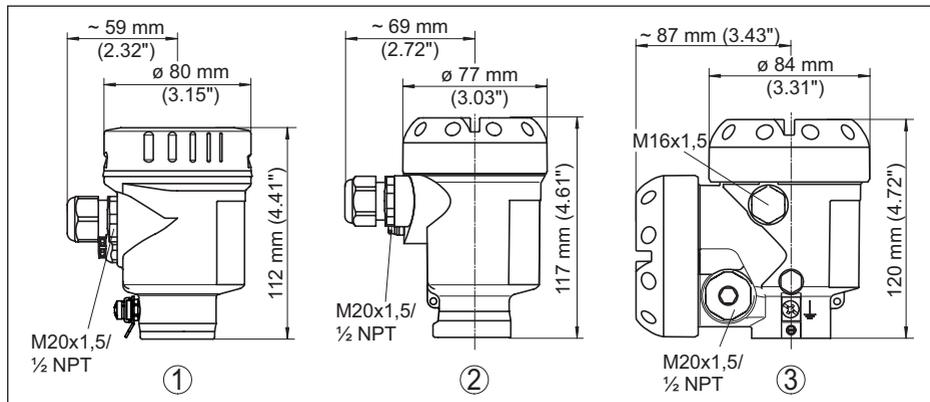
Fig. 46: Variantes de carcasa en grado de protección IP66/IP67; 1 bar (con módulo de visualización y configuración integrado aumenta la altura de la carcasa en 9 mm/0.35 in)
