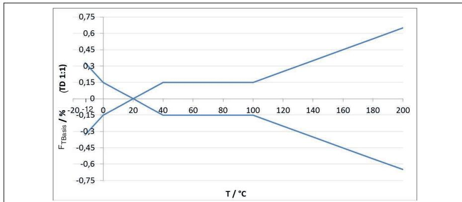
Fig. 38: Error de temperatura básico  $F_{TBasis}$  con TD 1 : 1
