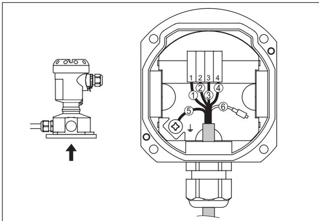
Fig. 26: Conexión del módulo de proceso en el zócalo de la carcasa
