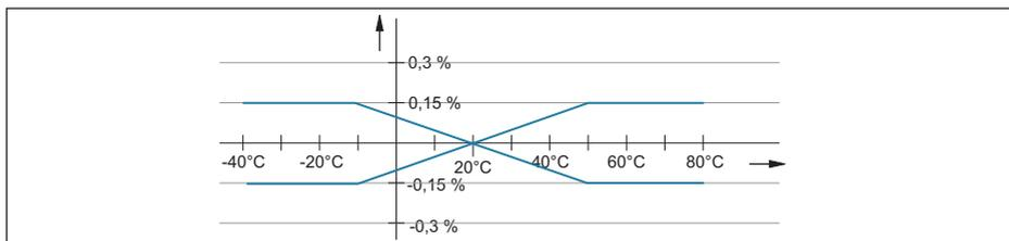
Fig. 39: Variación térmica salida de corriente
