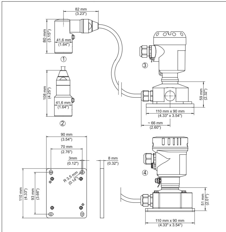
Fig. 49: Versión IP68 con carcasa externa
