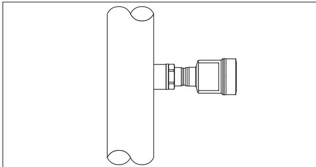
Fig. 1: Medición de presión de proceso con CPT-2x
