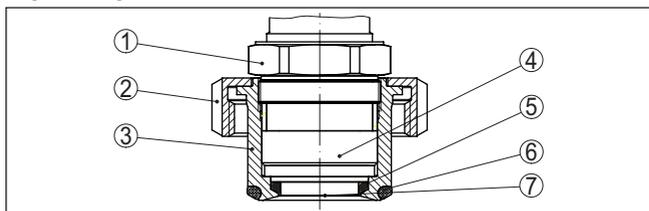
Fig. 33: CPT-2x, estructura de la conexión aséptica con tuerca de unión ranurada
