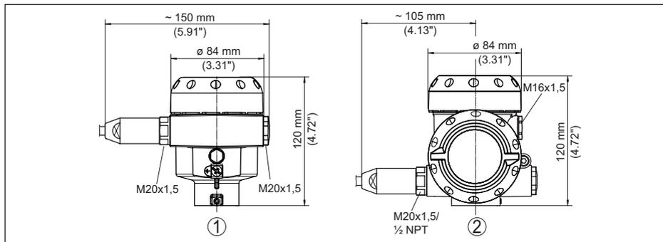
Fig. 45: Variantes de carcasa en grado de protección IP66/IP68 (1 bar), (con módulo de visualización y configuración integrado aumenta la altura de la carcasa en 9 mm/0.35 in)
