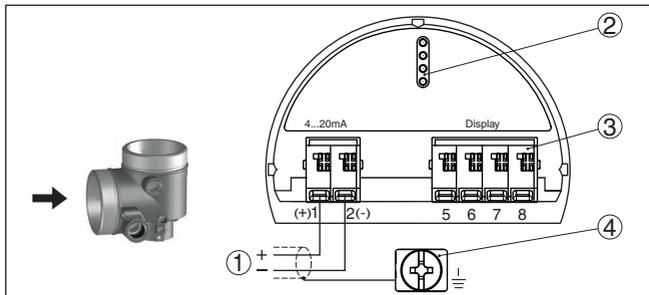
Fig. 22: Compartimiento de conexiones - Carcasa de dos cámaras
