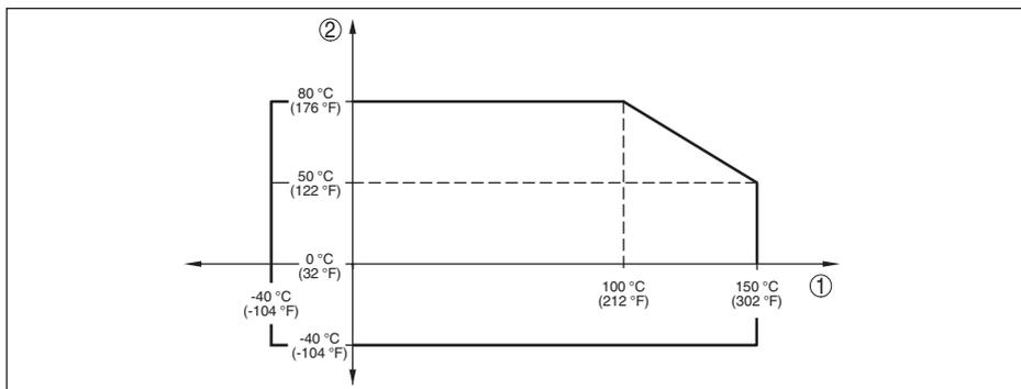
Fig. 41: Reducción de temperatura CPT-2x, versión hasta +150 °C (+302 °F)
