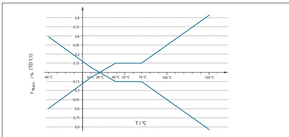
Fig. 37: Error de temperatura básico  $F_{TBasis}$  con TD 1 : 1
