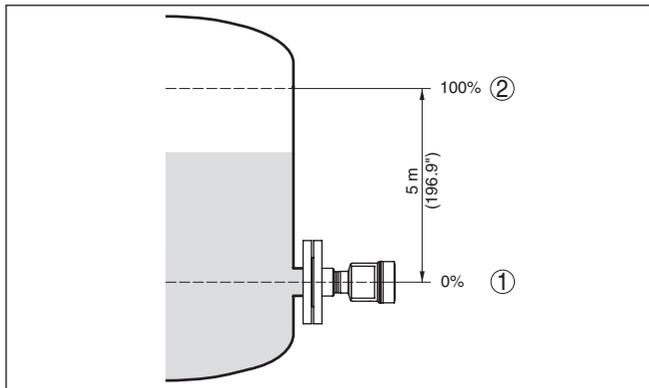
Fig. 31: Ejemplo de parametrización ajuste mín./máx. medición de nivel
