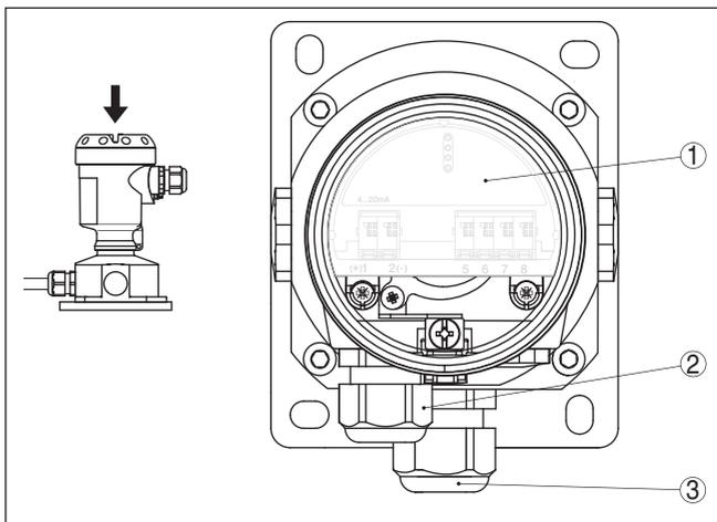
Fig. 25: Compartimento de la electrónica y de conexiones
