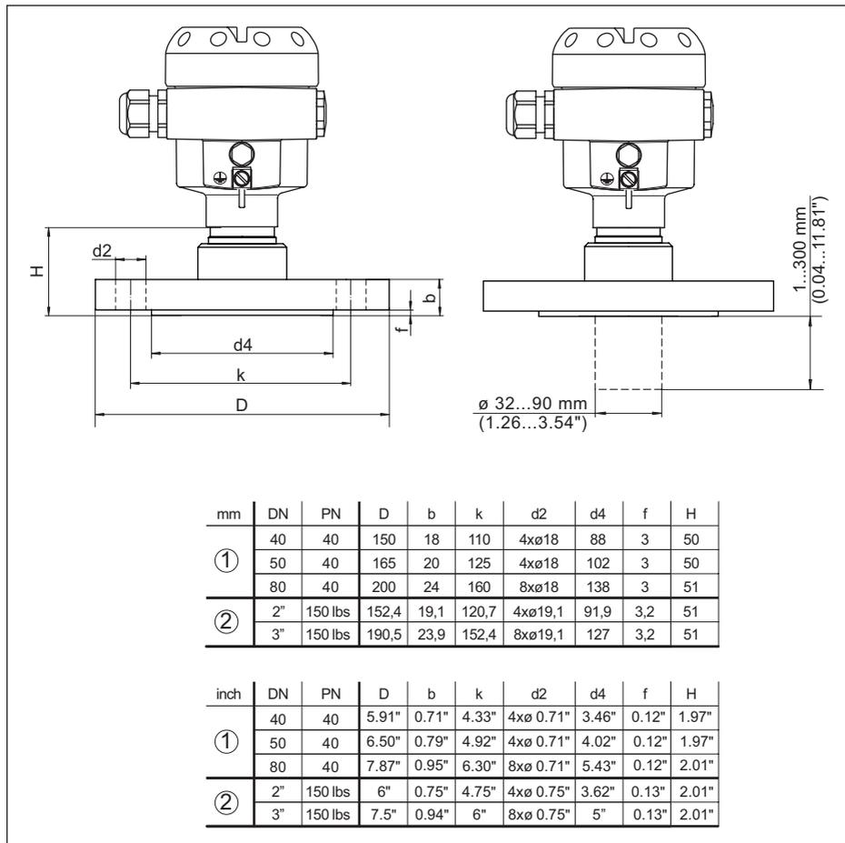
Fig. 53: CPT-2x, Conexión de brida
