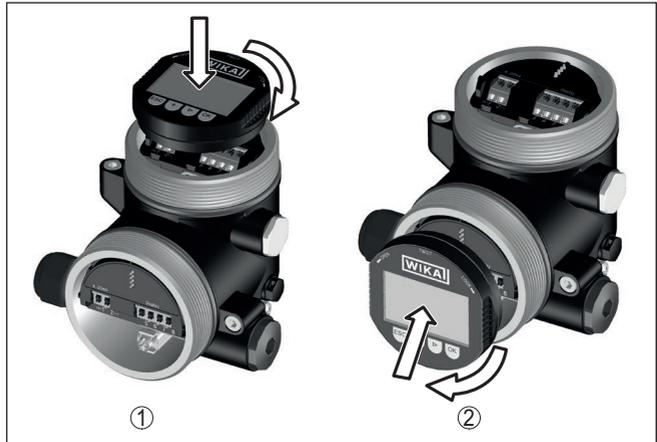
Fig. 29: Empleo del módulo de visualización y configuración en carcasa de dos cámaras
