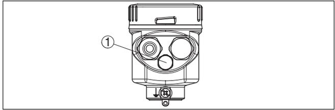
Fig. 13: Posición del elemento de filtrado - versión IP69K
