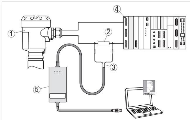
Fig. 32: Conexión del PC a la línea de señal vía HART
