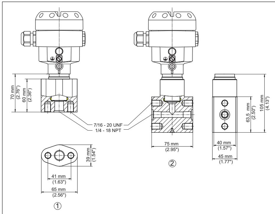
Fig. 55: CPT-2x, conexión según IEC 61518
