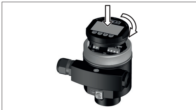
Rys. 28: Wkładanie modułu wyświetlającego i obsługowego do komory układu elektronicznego w obudowie jednokomorowej
