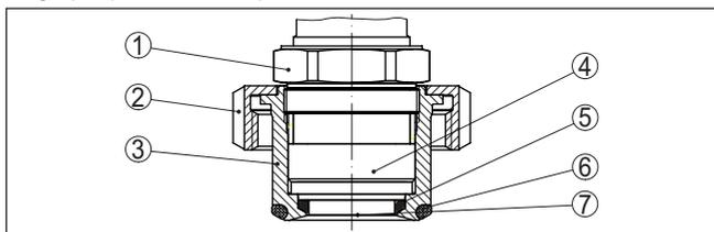
Fig. 28: CPT-2x, structure du raccord hygiénique avec écrou flottant à encoche
