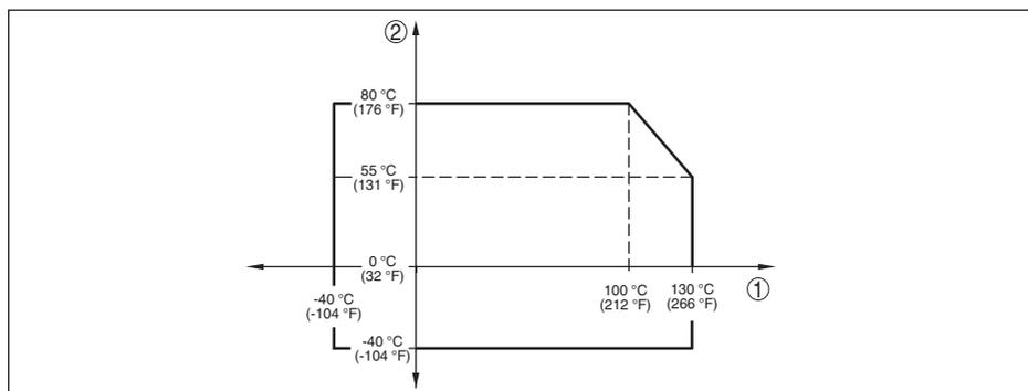
Fig. 32: Derating de température CPT-2x, version jusqu'à +130 °C (+266 °F)
