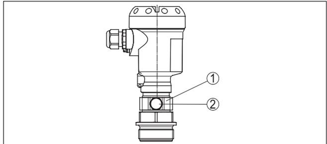
Fig. 11: Position de l'élément filtre - version Ex d
