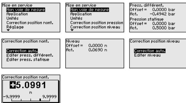
Lors d'une correction de position automatique, la valeur de mesure actuelle est transférée comme valeur de correction. celle-ci ne doit dans ce cadre pas être faussée par l'immersion du produit ou une pression statique.
