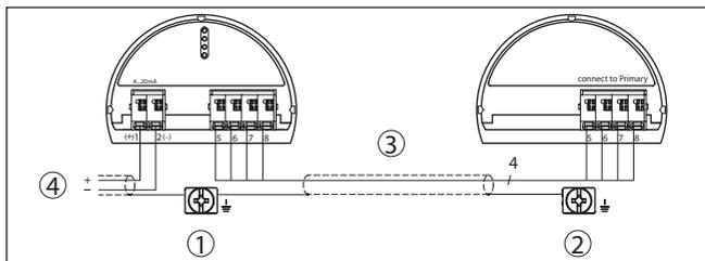
Fig. 26: Exemple de raccordement pression différentielle électronique
