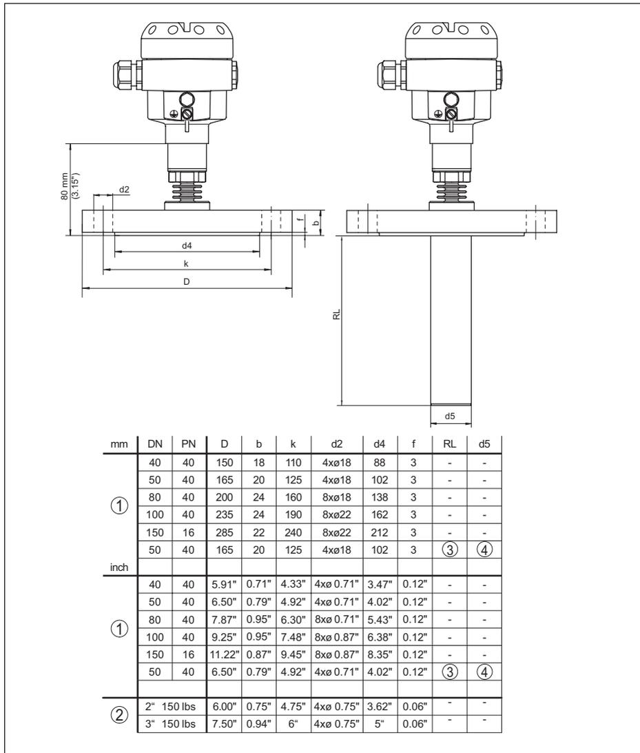
Fig. 41: IPT-2x, raccord à bride +150 °C (cellule de mesure jauge extensométrique/piézorésistive)
