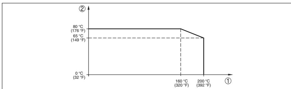
Fig. 33: Derating de température IPT-2x, version jusqu'à +200 °C (+392 °F)
