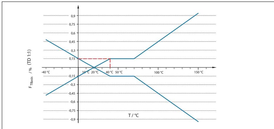
Fig. 34: Détermination de l'erreur de température de base pour l'exemple ci-dessus :  $F_{T\text{Base}} = \mathbf{0,15 \%}$
