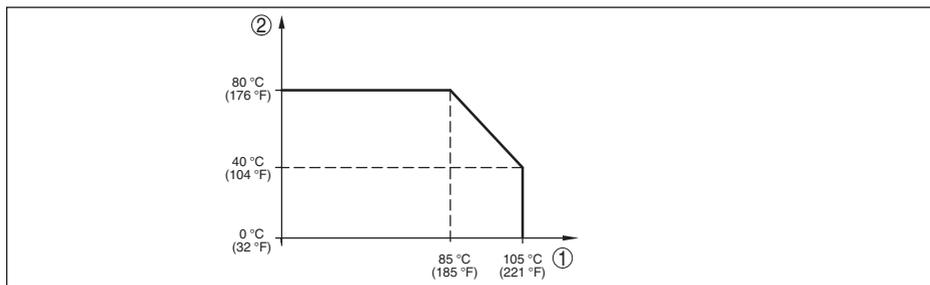
Fig. 29: Derating de température IPT-2x, version jusqu'à +105 °C (+221 °F)
