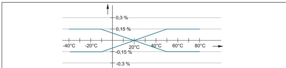
Fig. 28: Variation thermique sortie courant
