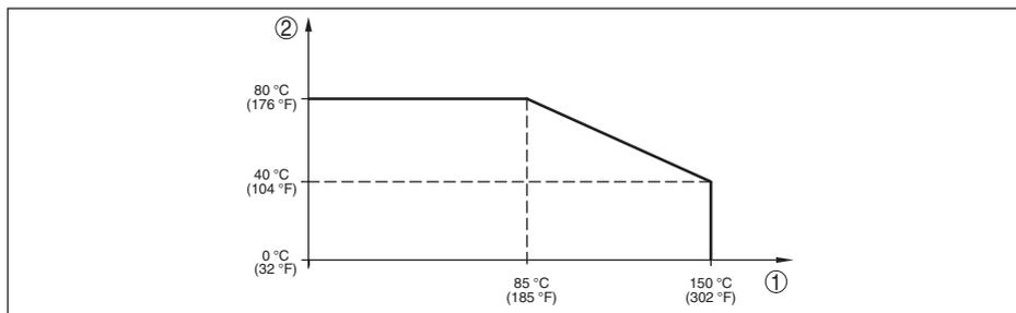
Fig. 30: Derating de température IPT-2x, version jusqu'à +150 °C (+302 °F)
