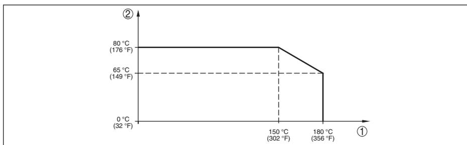
Fig. 32: Derating de température IPT-2x, version jusqu'à +180 °C (+356 °F)
