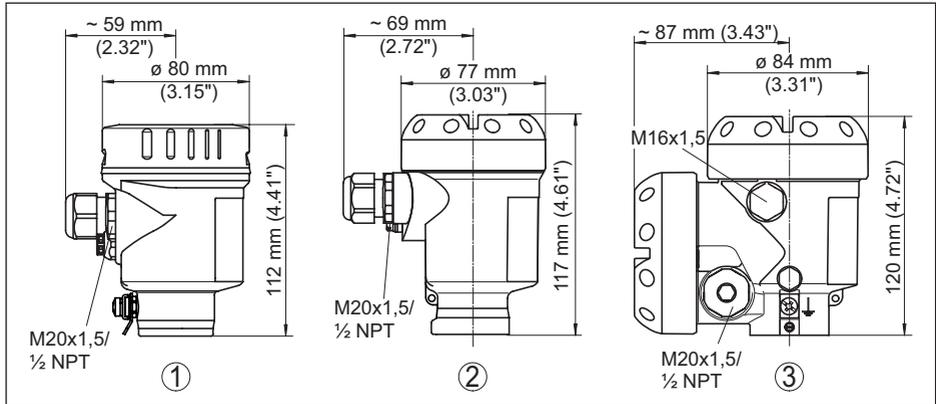
Fig. 44: Variantes de boîtier en protection IP66/IP68 (0,2 bar), (avec un module de réglage et d'affichage intégré, la hauteur du boîtier augmente de 9 mm/0.35 in)
