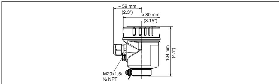
Fig. 46: Variante de boîtier en protection IP69K (avec un module de réglage et d'affichage intégré, la hauteur du boîtier augmente de 9 mm/0.35 in)
