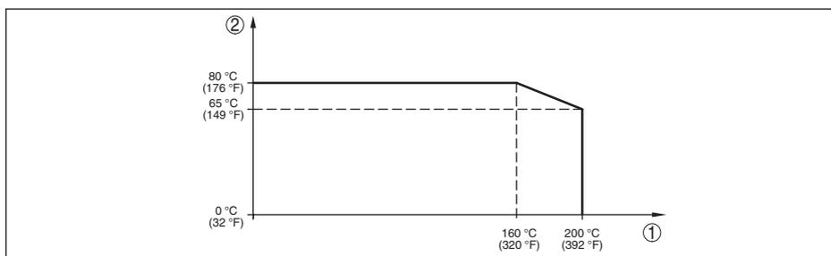
Fig. 39: Derating de température IPT-2x, version jusqu'à +200 °C (+392 °F)
