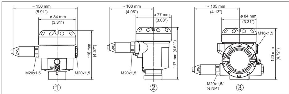
Fig. 45: Variantes de boîtier en protection IP66/IP68 (1 bar), (avec un module de réglage et d'affichage intégré, la hauteur du boîtier augmente de 9 mm/0.35 in)
