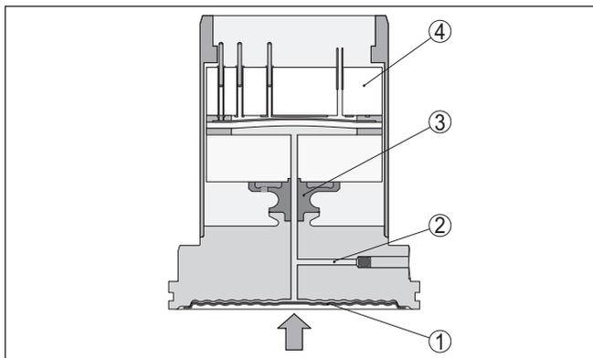
Fig. 4: Structure de la cellule de mesure céramique/métallique
