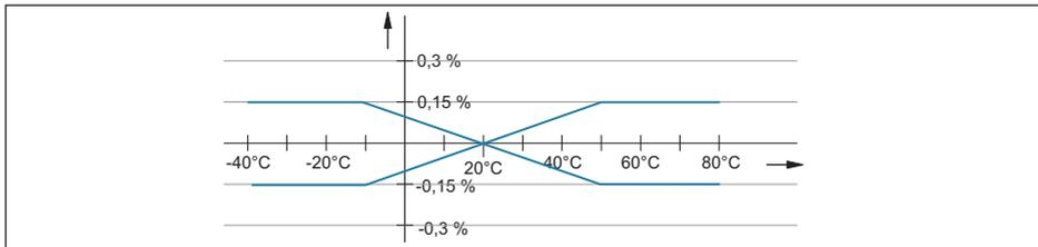
Fig. 34: Variation thermique sortie courant
