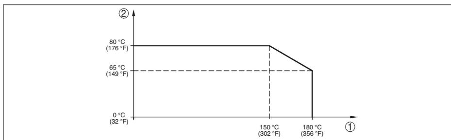
Fig. 38: Derating de température IPT-2x, version jusqu'à +180 °C (+356 °F)
