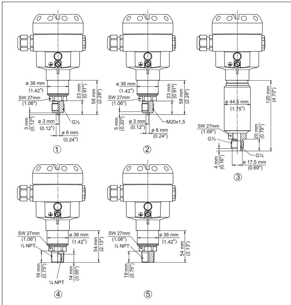
Fig. 48: IPT-2x, raccord fileté non arasant
