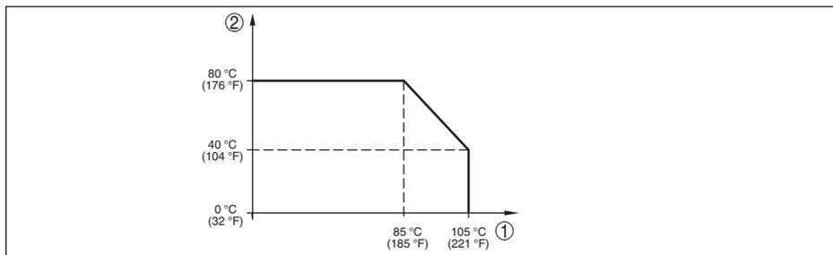
Fig. 35: Derating de température IPT-2x, version jusqu'à +105 °C (+221 °F)
