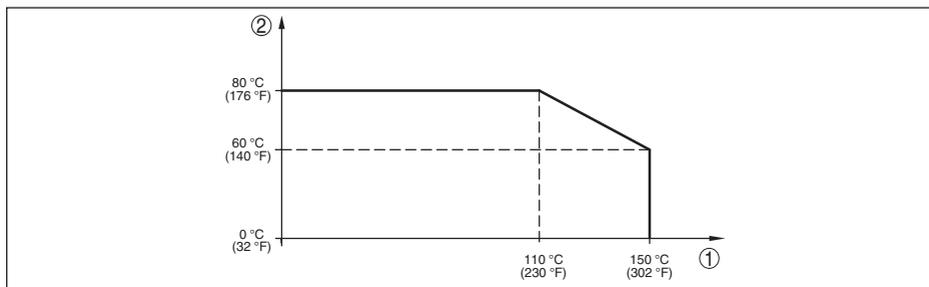
Fig. 37: Derating de température IPT-2x, version jusqu'à +150 °C (+302 °F)
