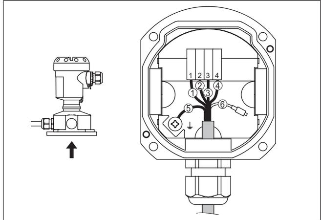
Fig. 22: Raccordement du module process dans le socle du boîtier
