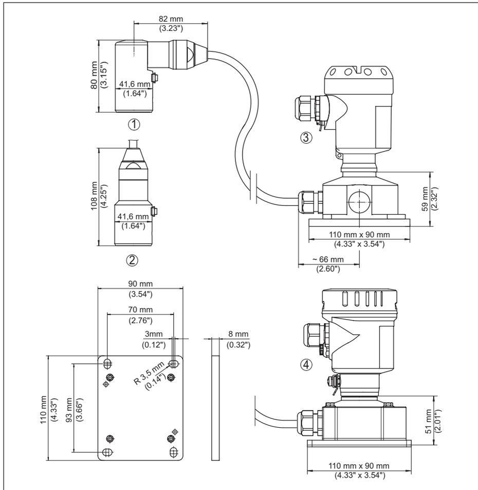
Fig. 47: Version IP68 (25 bar) avec boîtier externe
