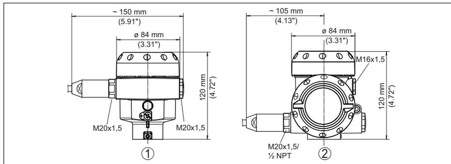
Fig. 43: Variantes de boîtier en protection IP66/IP68 (1 bar), (avec un module de réglage et d'affichage intégré, la hauteur du boîtier augmente de 9 mm/0.35 in)
