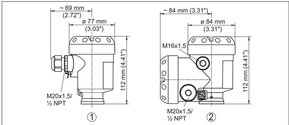
Fig. 41: Variantes de boîtier en protection IP66/IP67 (avec un module de réglage et d'affichage intégré, la hauteur du boîtier augmente de 9 mm/0.35 in)
