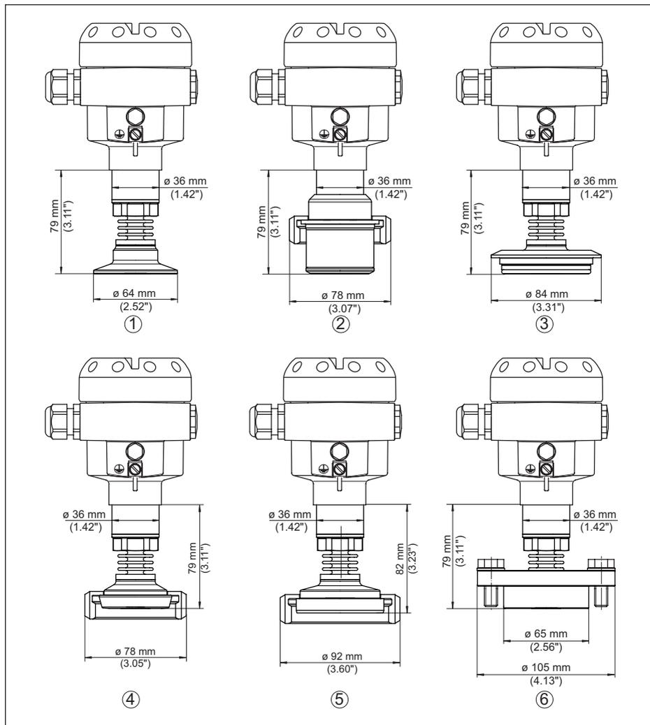
Fig. 50: IPT-2x, raccord hygiénique +150 °C (cellule de mesure jauge extensométrique/piézorésistive)
